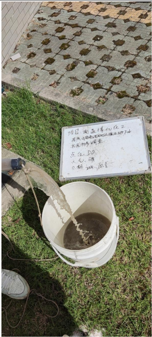
D0 点位地下水洗井
