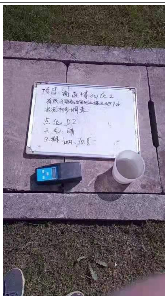
D2 点位洗井水质浊度检测
