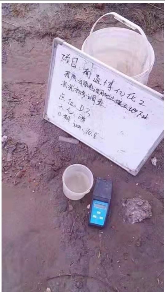
D3 点位洗井水质浊度检测
