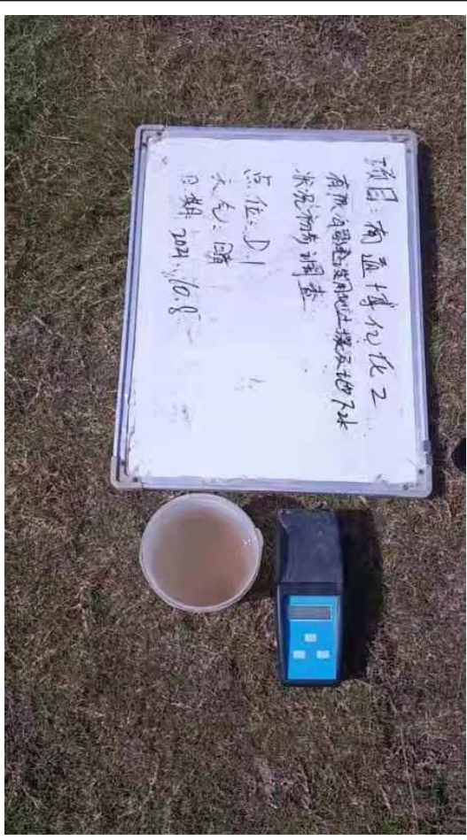
D1 点位洗井水质浊度检测
