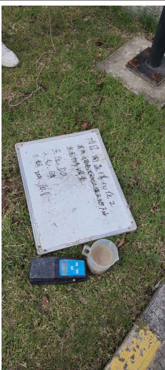
D0 点位洗井水质浊度检测
